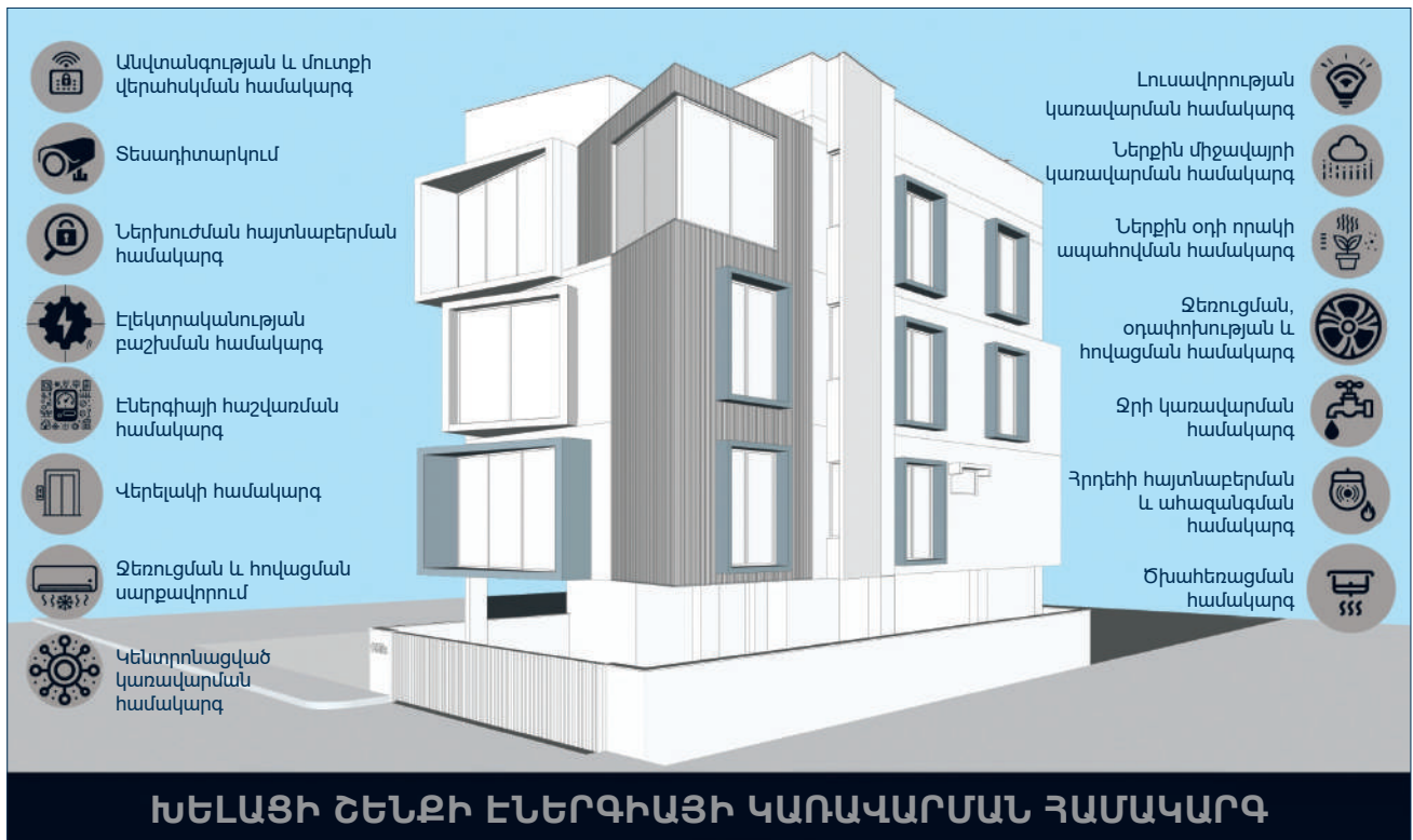
Նկար 51. Շենքի էներգետիկ կառավարման համակարգի տարբեր բաղադրիչները:
