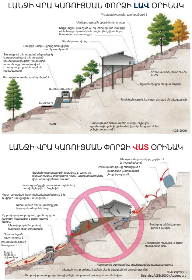
Նկար 10. Թեք լանդշաֆտի վրա կառուցված շենքերի լավ և վատ շինարարական պրակտիկաների սխեմատիկ օրինակներ:
